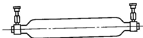
图 1 取样钢瓶示意图
