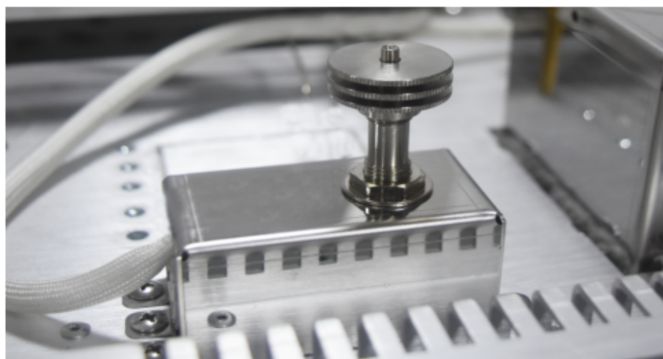
1 散热帽 2 进样垫 3 导向件 4 汽化管 5 铂电阻 6 加热管
